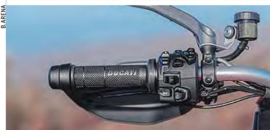
Simple Schaltzentrale: ein Joystick rechts der Hupe
