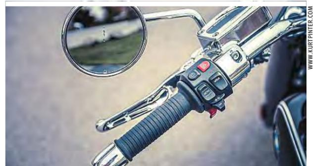
Schlicht und einfach: Die Bedienelemente am linken Lenkerende
