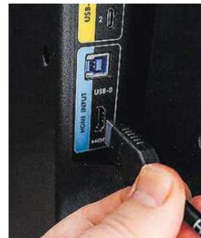
Bild- und Tonübertragung laufen hier über HDMI
